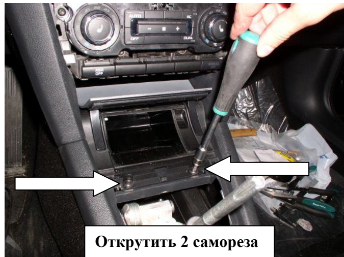
Разжать фиксатор, открутить и снять крышку и рукоятку рычага переключения передач
