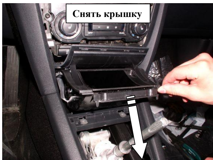
Разжать фиксатор, открутить и снять крышку и рукоятку рычага переключения передач
