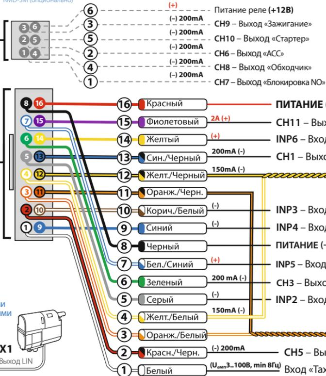
**ВНИМАНИЕ!** Все силовые цепи с использованием внешних реле и других исполнительных устройств, не питающихся от базового блока системы, должны иметь свои предохранители в цепи питания.
