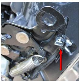
Снимите штатный замок капота.
