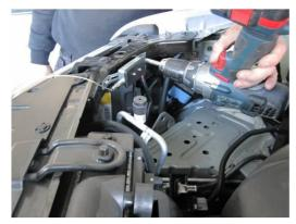
Прикрепите исполнительное устройство к кузову автомобиля. Для удобства используйте шуруповерт.
