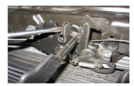
При помощи отвертки закройте штатный замок капота.
