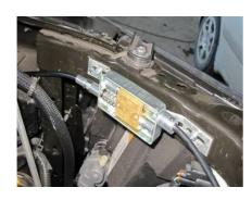
Откройте замок капота, потянув личину на себя. Отрежьте трос со стороны личины замка капота как показано на фото, оставив 10-13 мм. Наденьте на защиту троса стальную втулку, вставьте защиту троса в исполнительное устройство и при помощи шестигранного винта зафиксируйте трос в подвижном блоке исполнительного устройства.
