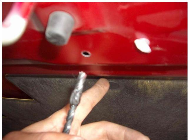
17. Используя «слепок» пластилина из п.16 как шаблон высоты, укоротите лишнюю резьбовую часть «сферы». Обратите внимание, что на некоторых автомобилях малое расстояние до внешней (лицевой) панели капота. Учтите это при регулировке длины резьбовой части.
