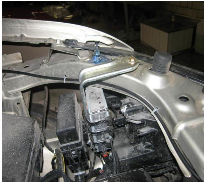
16. При помощи пластилина точно отметьте место крепления запорного элемента «сфера» на элементах капота. Просверлите отверстие диаметром 6мм.
