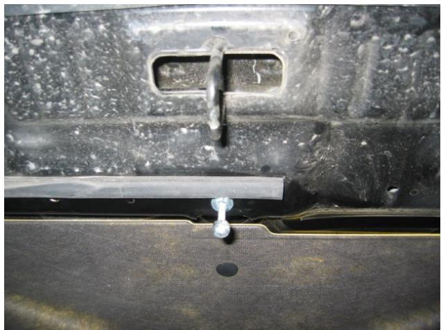
21. Проверьте свободный ход капота при закрытом замке Megalock. При открытии штатного замка капота капот под действием пружины должен приоткрываться на 2-3 мм. При необходимости отрегулируйте свободный ход открытия капота, вкручивая или выкручивая резьбовую часть «сферы». Обратите внимание, чтобы не «перевернуть» резьбовую часть до контакта с внешней поверхностью капота, возможно повреждение поверхности!
