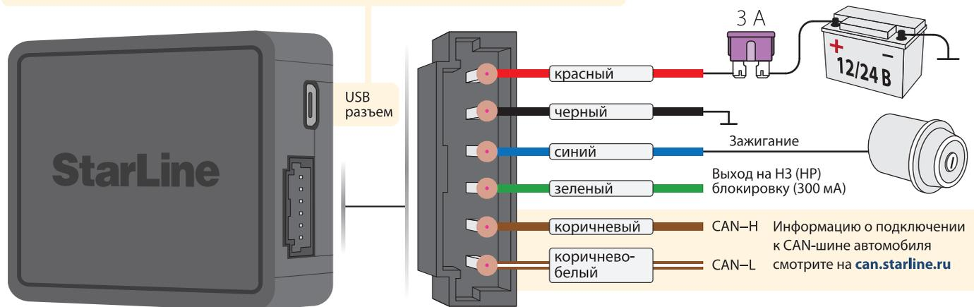
**StarLine M66** — телематический трекер предназначен для мониторинга автотранспорта с функцией иммобилайзера. Авторизация владельца происходит по шифрованному протоколу Bluetooth Smart (BLE), защищенному от электронного взлома.
